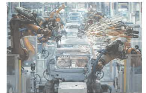
Obr. 4 – Robotizovaná výrobní linka automobilů, která umožňuje rychlejší, levnější a přesnější výrobu
